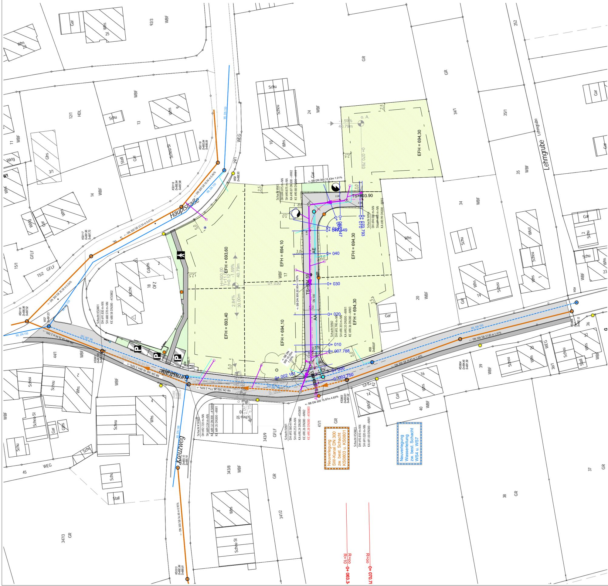
Neuerlegung SW-Kanal DN 300 mit best. Schacht KS0003 u. KS0001
