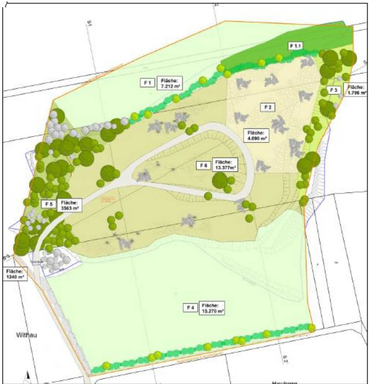
Abbildung 1: Maßnahmenplan mit Flächengrößenangaben (ohne Maßstab) (Quelle: Auszug aus dem Maßnahmenplan der Anzeige der Stilllegung 2016)
